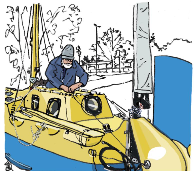
Un mécanisme original de direction actionné par des bouts. Le gouvernail peut même être facilement relevé depuis le 'poste de commande' afin de garder un faible tirant d'eau. Au premier plan, sur le pont, nous pouvons distinguer la godille, qui rend bien des services dans la pétrole. Les bras aidant aussi un peu il faut l'avouer...
